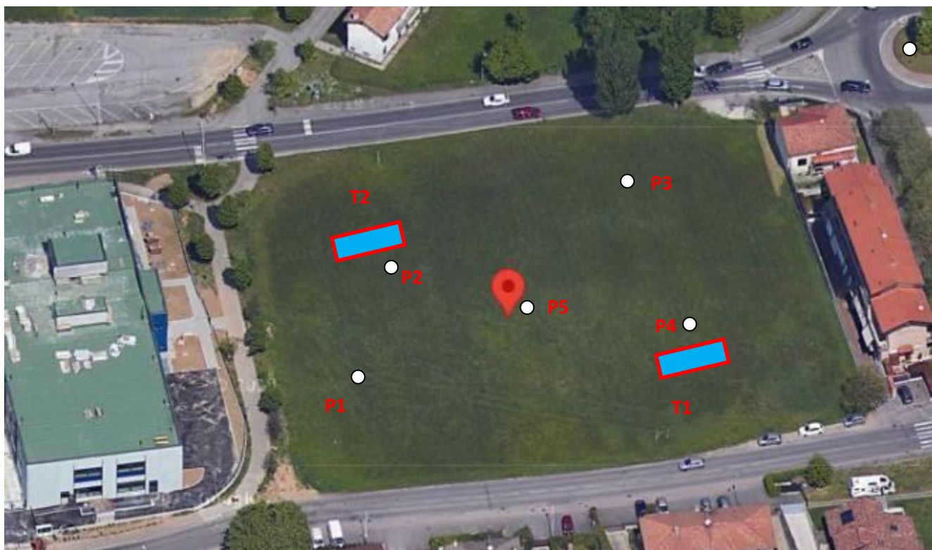
fig. 1 - Ubicazione speditiva delle prove penetrometriche e delle trincee esplorative.
