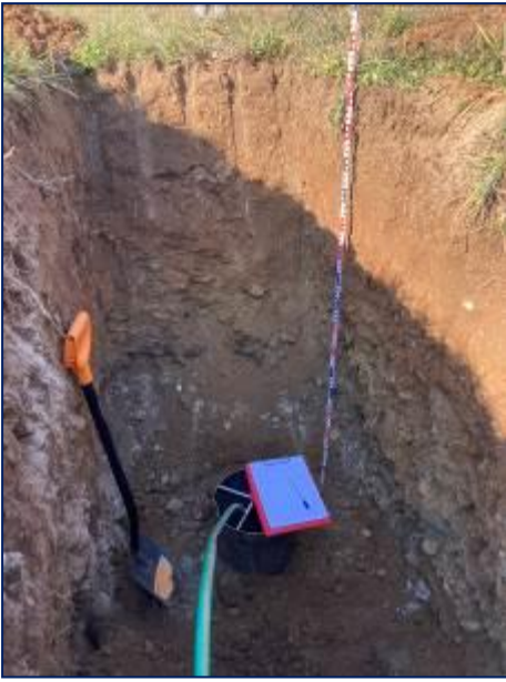
stratigrafia dalla trincea esplorativa T1 per l'effettuazione di prova infiltrometrica
