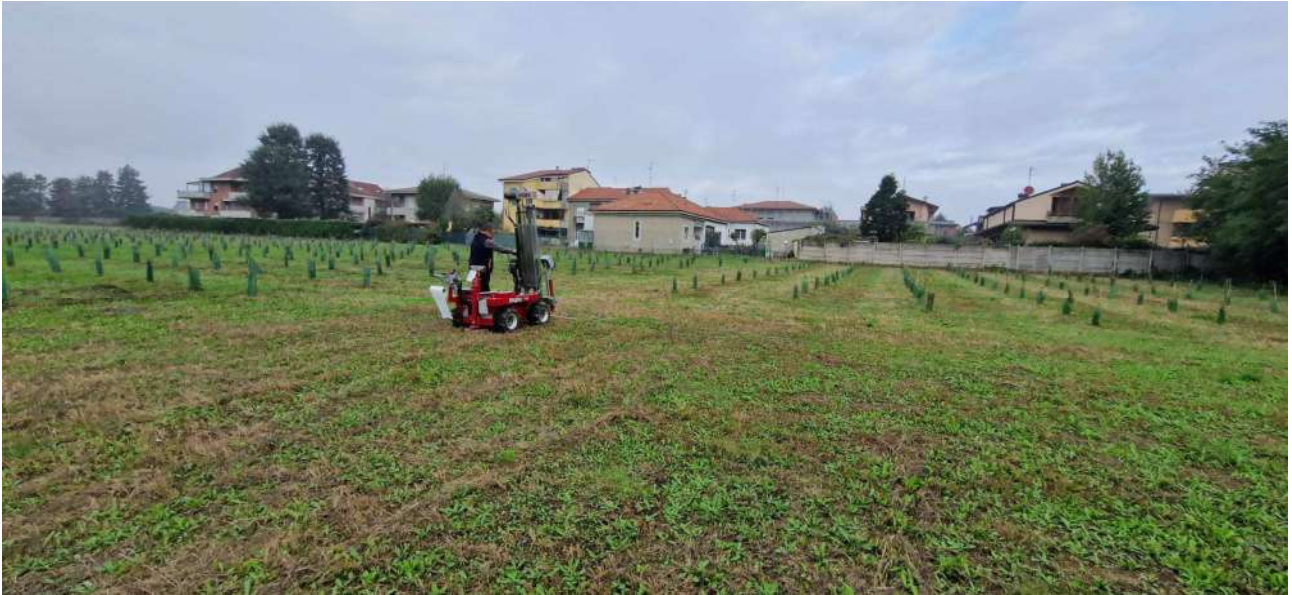
Prova penetrometrica P1
