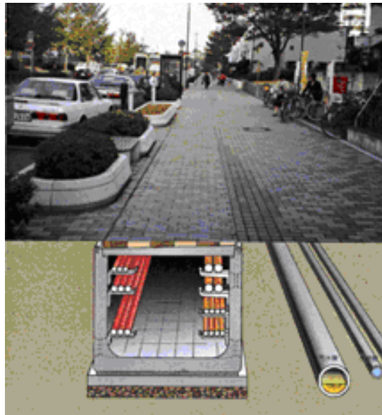
Strada infrastrutturata con cunicolo tecnologico
